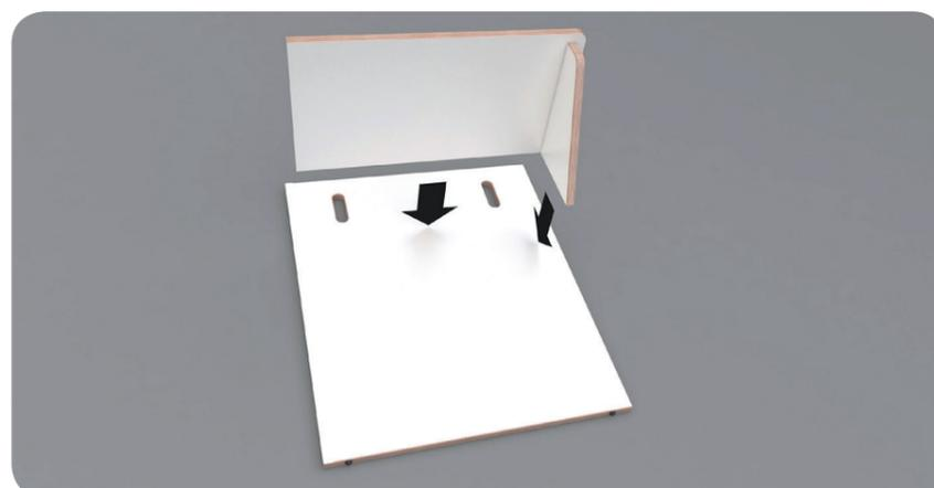
5. Die Seitenteile mit dem Sitz und dem Tisch auf die Grundplatte aufsetzen, so dass der Sitz und der Tisch jeweils auf der Grundplatte aufliegen und die Seitenteile seitlich neben der Grundplatte stehen. Die Verbinder zusammenstecken und mit dem Inbus festziehen.
